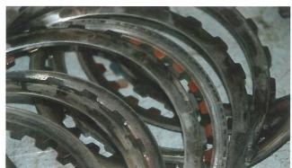
schlissene Reiblamellen können auf Öl mit mangelhaften Schmiereigenschaften oder ungeeigneten Schmierstoff zurückgehen. Genauso verschleißt ATF, wenn Lamellen rutschen und es zu dauerhaft hohen emperaturen kommt.
