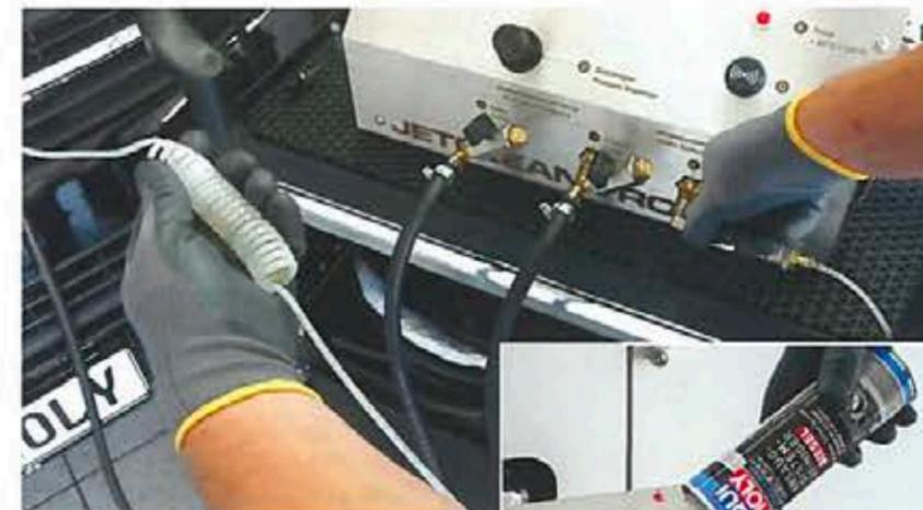
Bei Selbstzündern gelangt der Reiniger per Überdruck in den Ansaugbereich. Die durchsichtige Wendel hilft beim Dosieren. Der ‚Pro-Line‘-Ansaugsystemreiniger ist gebrauchsfertig vorgemischt (kt. Bild).
