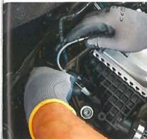
Über die Bohrung des Drucksensor gelangt die Reinigungsflüssigkeit auf kürzestem Wege in den Ansaugtrakt, um AGR-Ventil, Einlassventile und die gesamte Ansaugstrecke von störenden Öl- und Rußablagerungen zu befreien.
