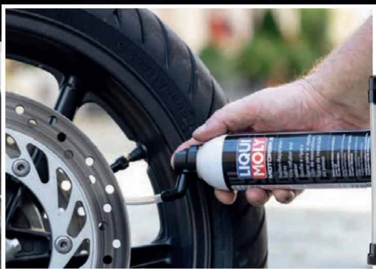
Für den Pannenfall gut gerüstet: Das Motorbike Reifen-Reparatursspray (Art.-Nr. 1579) dichtet platte Reifen ab und pumpt sie wieder auf.
