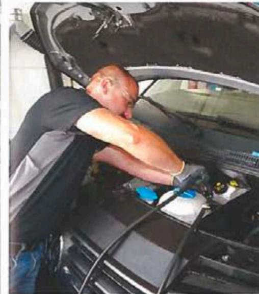
Der Einspritzsystemreiniger gelangt direkt über den Vorlauf der Hochdruckpumpe zu den Injektoren. Der fahrzeugseitige Rücklauf ist dabei überbrückt. Fahrzeugspezifische Adapter gibt es als Zubehör, um ein professionelles Arbeiten mit dichten Verbindungen sicherzustellen.
